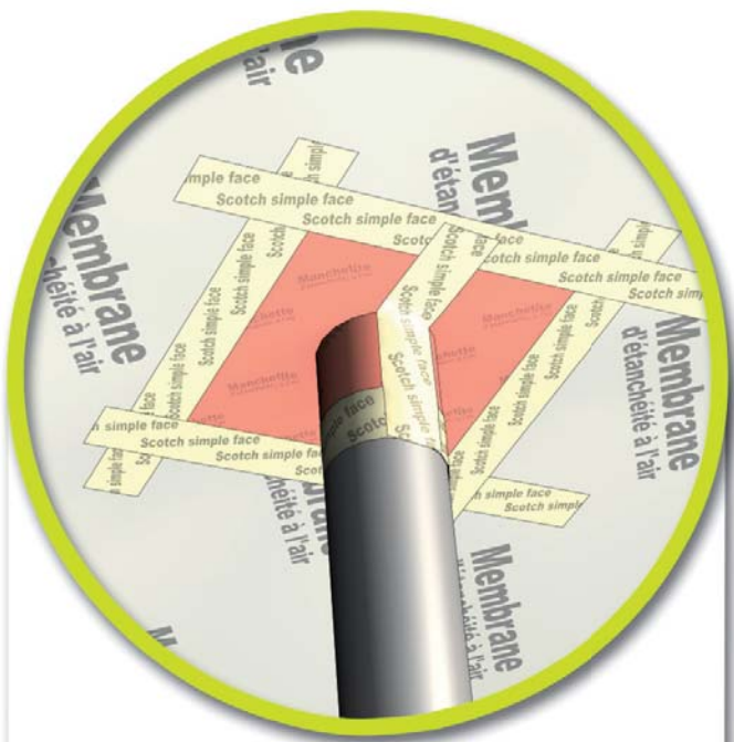
Traversée par des tuyaux de gros diamètre
