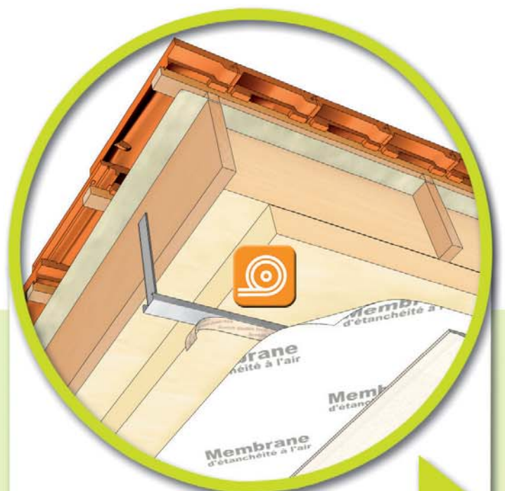
Membrane scotchée sur rail
