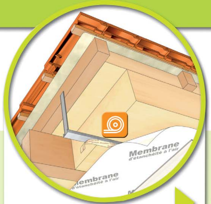
Membrane scotchée sur rail
