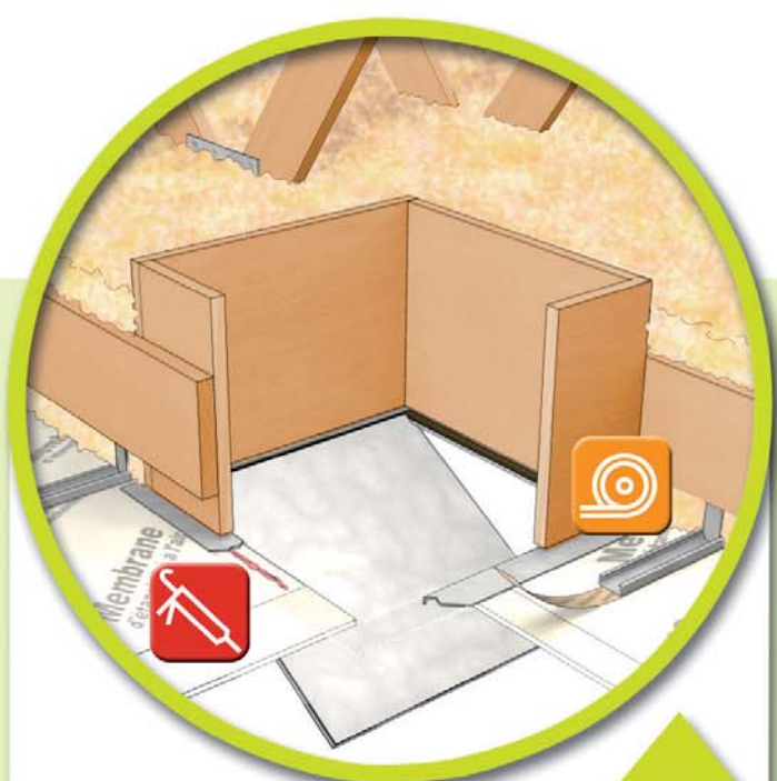
Raccordement à une trappe
